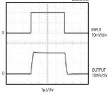
$$\begin{split} &V_{CC}=\pm 2.5V\\ &R_L=1k\Omega,\ C_L=15pF\\ &A_V=1V/V \end{split}$$
