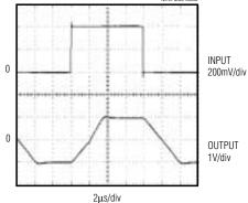
$$\label{eq:CC} \begin{split} &V_{CC}=\pm2.5V\\ &R_L=1k\Omega,\;C_L=15pF\\ &A_V=5V/V \end{split}$$
